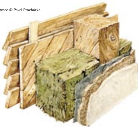
Lehká dřevěná konstrukce vyplněná minerální vatou.
