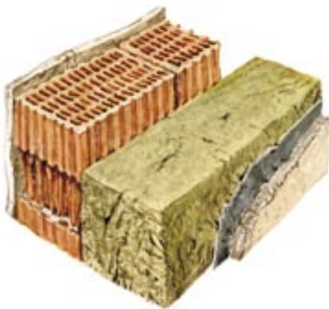
Masivní cihlová zeď s 25 cm nalepené minerální izolace na vnější straně.
